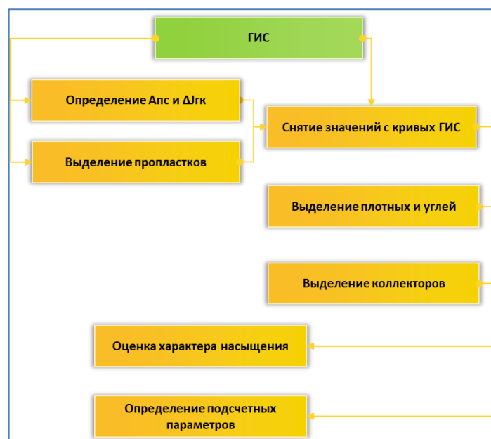
Рисунок 12 – Структура модуля стандартной интерпретации
